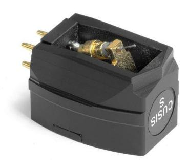
Ein Generator japanischer Herkunft und ein Samarium-Kobalt-Magnet: Daraus sind die Tonabnehmer aufgebaut. Ihr Gehäuse ist bei den Systemen Cusis E/H und S aus Polyacetal und nur durch die Schrauben, mit denen das System an der Headshell montiert wird, fest mit dem Generator verbunden. Das Cusis S verfügt über eine Nadel mit Shibata-Schliff, die in einem Nadelträger aus Bor steckt
